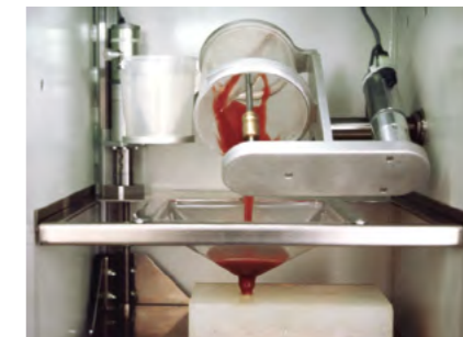
Das Vakuumgießverfahren ermöglicht die Herstellung von Teilen mit einem ausgezeichneten optischen Aspekt sowie besten mechanischen Eigenschaften
