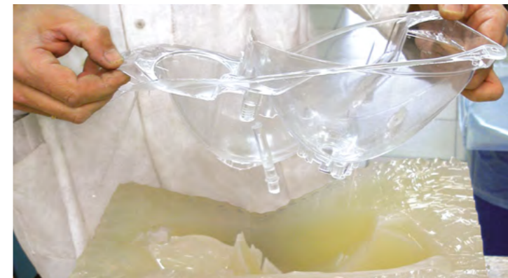
Elastische Form aus additionsvernetzendem Silikon ESSIL 291 für Teile mit gutem visuellen Aspekt
