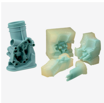
5 Gießen von Wachsteilen für den Feinguss
