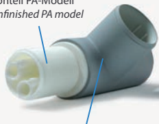
1. Arbeitsgang: Lackieren mit Spritzfüller und schleifen 1. Operation: Lacquer with spray-on filler and polish
