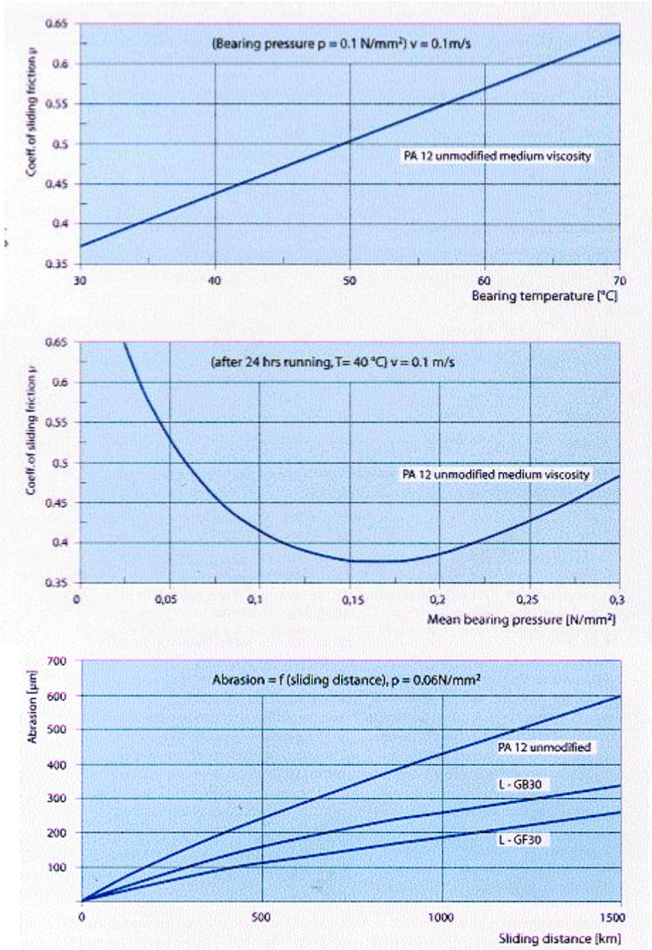
Gleitreibzahl in Abhängigkeit von Lagertemperatur (Lubrimeter-Test nach A.Bartel)
