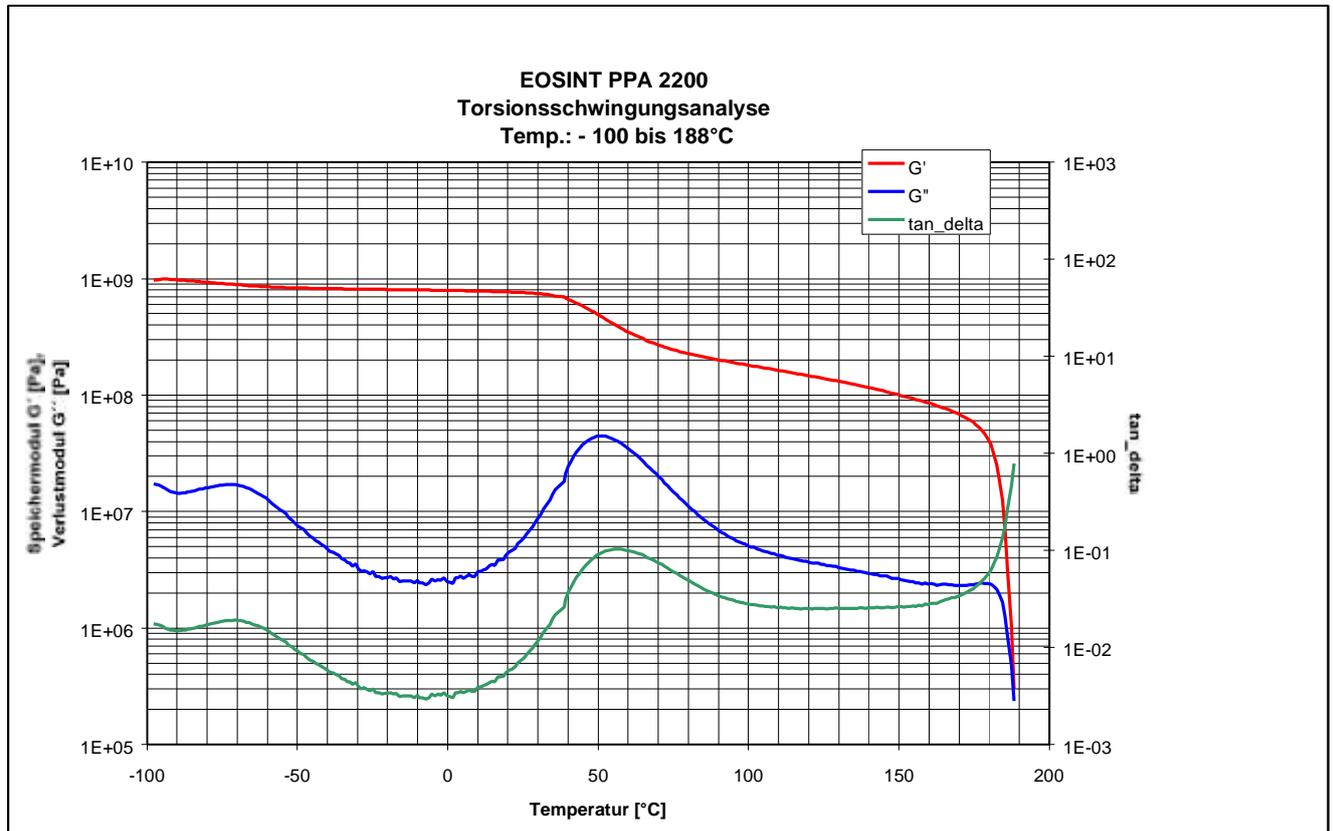
Generell weisen Polyamid12 - Teile im Temperaturbereich von - 40°C bis + 80°C unter dauerhafter Belastung eine hohe mechanische Festigkeit und Elastizität auf. Kurzzeitige Temperaturbeanspruchungen ohne Belastung sind bis Temperaturen von 160°C möglich.
