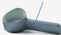
2. Arbeitsgang: Weitere Lackierung mit Spritzfüller und Schliff 2. Operation: Another lacquering with spray-on filler and polish
